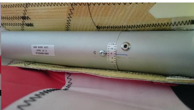
16. Vérifier que les arrières de Bords d'attaque et leurs manchons de bouts d'aile soient bien installés du bon côté de l'aile en fonction de leurs marquages Droite/Gauche.
